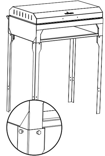
Luego, colocar los refuerzos cortos para unir las patas delanteras con las traseras, utilizando la perforación inferior de las mismas, dejando el rebaje del refuerzo mirando hacia arriba. Utilizar los tornillos hexagonales cortos y ajustar las tuercas para fijar las piezas en su posición pero que permita moverlas levemente.
