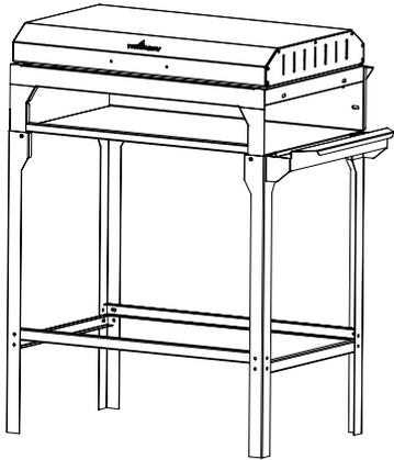
Por último, colocar el estribo soporte del fogonero sobre el lateral derecho de la parrilla, que corresponde al lado abierto de la caja de fuego. Utilizar los tornillos hexagonales largos, reemplazando los dos tornillos cortos previamente colocados, ajustar las tuercas para fijar las piezas en su posición pero que permita moverlas levemente.
