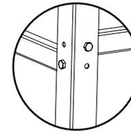
Una vez instalados los refuerzos cortos, colocar los refuerzos largos para terminar de cerrar la estructura de la base de la parrilla, haciendo encastrar el extremo del mismo con los rebajes antes mencionados. Utilizar los tornillos hexagonales cortos y ajustar las tuercas para fijar las piezas en su posición pero que permita moverlas levemente.
