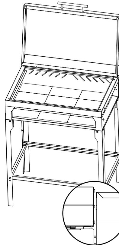
Luego, fijar el fogonero a la espalda de la caja de fuego utilizando un tornillo hexagonal corto, y ajustar las tuercas para fijar las piezas en su posición pero que permita moverlas levemente.
